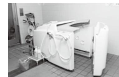
車いすのまま入浴できる機械も導入済。介護者の負担も軽減しています
