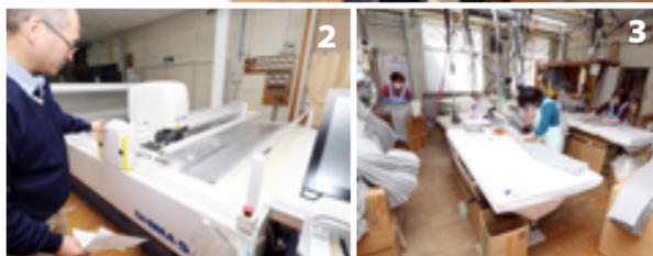
1\_ 広い職場はミシンや機械が並び、1日に約200~300着の縫製が手作業で行われます。若い人や未経験の人でも安心して仕事ができるように、使いやすい新型のミシンも導入しています/2\_12月に稼動した最新の機械。コンピューターで入力した図面通りに型を裁断します/3\_プレスされ丁寧に梱包された製品は、検針機で異物が入っていないことを確認し、関東のお得意様へ配送された後に全国の販売店へ出荷されます
