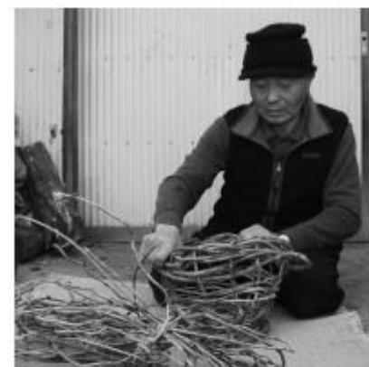
はじめに籠の部分を編み、その後台を作り「つる」で固定します
