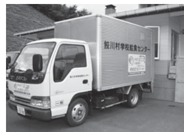
バイオディーゼル燃料で走る学校給食配送車。廃食用油も貴重な資源の一つとして回収、精製し、燃料に生まれ変わります。
